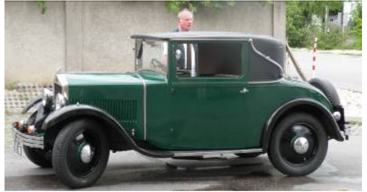
Mathis Typ PYC Baujahr 1931 ca. 1200ccm, 4Zylinder, Viertakt-Reihenmotor, 32Ps
