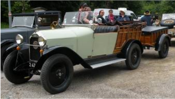
Mathis Typ M Normandie Baujahr 1924 4Zyl. Viertaktreihenmotor Wasserkühlung, 995ccm, 4 Gang, 4 Sitzer, Eigengew.: 880kg Einzigler leichter Anhänger von Mathis
