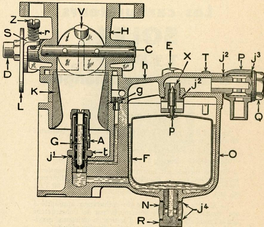
Fig. 3. — Coupe du carburateur vertical type FV à starter
