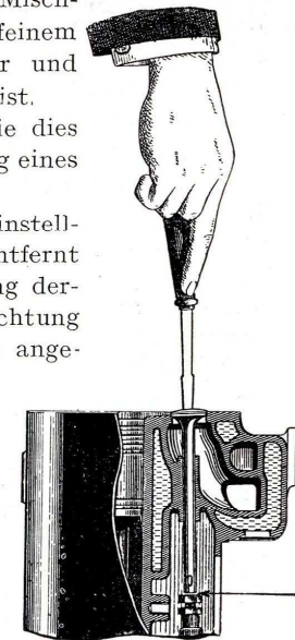
Abb. 8. Einschleifen der Ventile.
